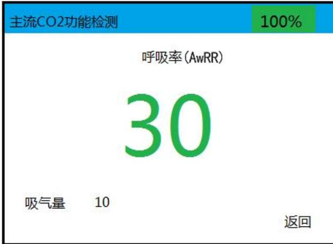
**呼吸率：**通过方向键可以更改呼吸率的数值，当确认数值后，发生器将产生对应的控制信号
